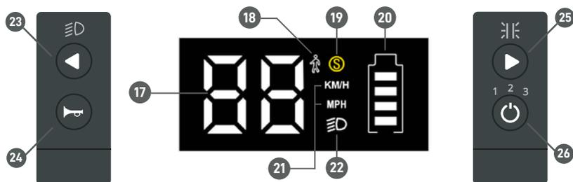
(17). Vitesse instantannée (18). Mode de vitesse 1 (19). Mode de vitesse 2 & 3 (20). Indicateur niveau de batterie (21). Indicateur type vitesse (22). Indicateur d'activation des feux (23). Bouton activation feux et clignotant gauche (24). Klaxon (25). Bouton activation LED rouges et clignotant droit (26). Bouton ON/OFF et mode de vitesse.
