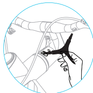
Coppia di serraggio 12 \pm 0.5 \text{ Nm}
