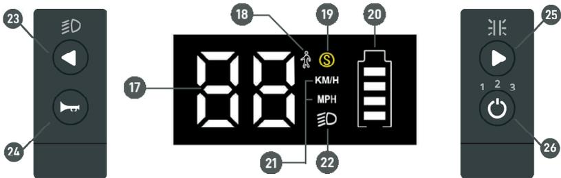
(17). Aktuelle Geschwindigkeit (18). Geschwindigkeitsmodus 1 (19). Geschwindigkeitsmodus 2 und 3 (20). Akkustandsanzeige (21). Einheit Geschwindigkeitsanzeige (22). Kontrollleuchte für die Beleuchtung
