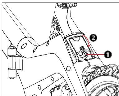
1. Для извлечения батареи выключите устройство, разблокируйте батарею с помощью ключа (1) и снимите корпус батареи, опустив и потянув за ручку (2).
