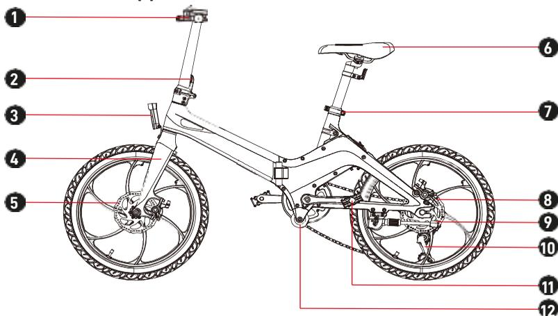
(1). Ручки управления, тормозные рукоятки, экран и колокольчик (2). Складная система (3). Передние фары (4). Передняя вилка (5). Передний тормозной диск (6). Регулируемое седло (7). Регулировка высоты сиденья (8). Задний тормозной диск (9). Стойка (10). Дерайлер (11). Педаль с отражателем (12). Опорное колесо.
