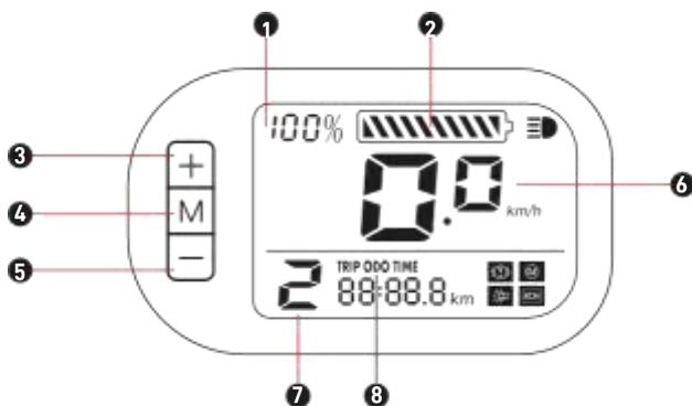
(1). Уровень заряда аккумулятора (%) (2). Уровень заряда батареи (3). + кнопка (4). Кнопка М (5). - Кнопка (6). Кнопка скорости (7). Уровень помощи (1: 15 км/ч; 2: 20 км/ч; 3: 25 км/ч) (8). Режим отображения пробега
