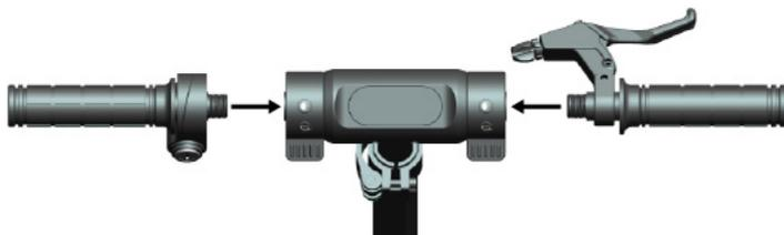
4. Aparafuse os punhos um a um no eixo do guidador. Não aparafuse nem force se o punho estiver torto. O punho deve ser aparafusado sem forçar.
