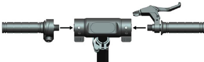
**4.** Avvitare le impugnature una alla volta sull'asse del manubrio. Non avvitare e non forzare se l'impugnatura non è perfettamente dritta. L'impugnatura deve potere essere avvitata senza esercitare alcuna forza.
