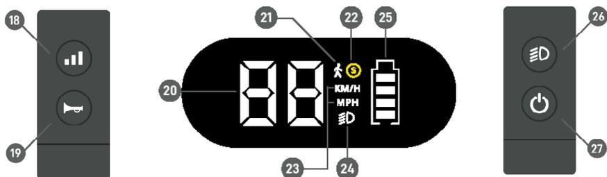
(18). Cambio di velocità (19). Segnalatore acustico (20). Velocità istantanea (21). Modalità di velocità 1 (22). Modalità di velocità 2 e 3 (23). Indicatore della modalità di velocità (24). Indicatore di attivazione delle luci (25). Indicatore di livello della batteria (26). Pulsante di attivazione delle luci a LED (27). Pulsante di accensione/spengimento
