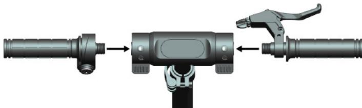
4. Una vez colocadas en el eje del manillar, apriete las manillas, una a una. No atornille ni fuerce la manilla si está torcida. Las manillas se deben apretar sin forzarlas.
