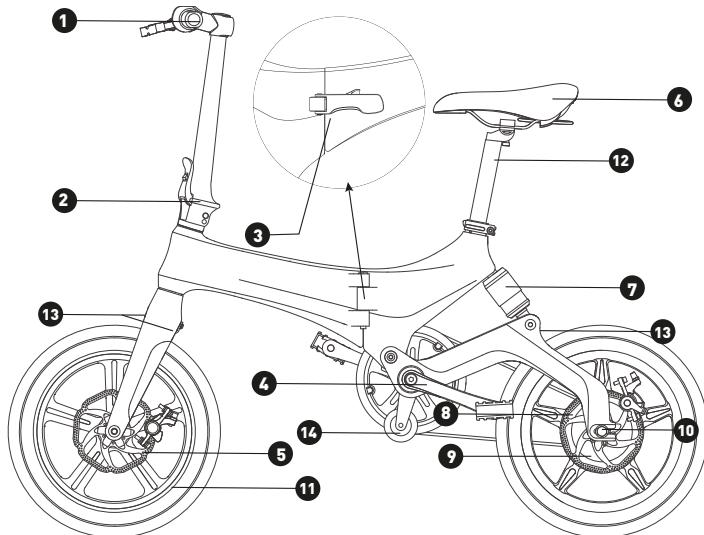
(1). Ручки управления, экран, педаль газа, колокольчики и тормозные рукоятки (2). Складная защелка для ручек (3). Складная защелка рамы (4). Педали (5). Передний тормоз (6). Регулируемое седло (7). Задняя подвеска (8). Задний тормоз (9). Двигатель (10). Колесный магнит (11). Светоотражающая лента (12). Необходимо добавить расположение света дальнего света (13). Местоположение брызговика, подлежащее добавлению (14). Защитное колесо для лотков
