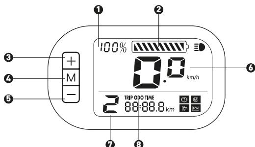
(1). Уровень заряда аккумулятора (%) (2). Уровень заряда батареи (3). + кнопка (4). Кнопка M (5). - Кнопка (6). Кнопка скорости (7). Уровень помощи (1: 15 км/ч; 2: 20 км/ч; 3: 25 км/ч) (8). Режим отображения пробега
