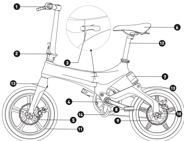
(1). Manubrio, parabrezza, pedale del gas, campanello e maniglie del freno (2). Chiusura pieghevole del manubrio (3). Chiusura pieghevole del telaio (4). Pedali (5). Freno anteriore (6). Sella regolabile (7). Sospensione posteriore (8). Freno posteriore (9). Motore (10). Magnete della ruota (11). Nastro riflettente (12). Posizione della luce abbagliante da aggiungere (13). Posizione del parafango da aggiungere (14). Ruota di protezione del vassoio
