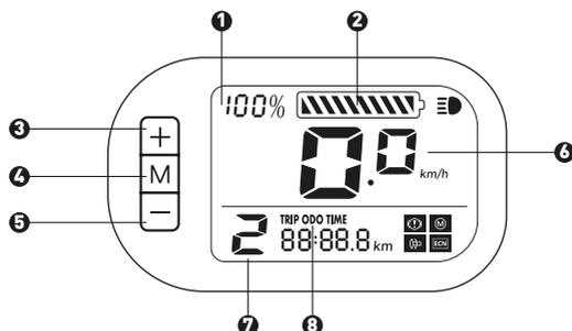
(1). Livello della batteria (%) (2). Livello della batteria (3). Pulsante + (4). Pulsante M (5). - Pulsante (6). Pulsante velocità (7). Livello di assistenza (1: 15 km/h; 2: 20 km/h; 3: 25 km/h) (8). Modalità di visualizzazione del chilometraggio
