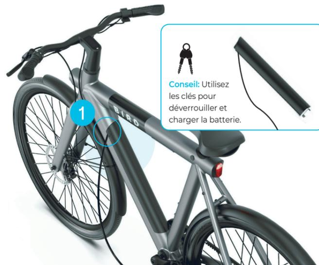
Conseil: Utilisez les clés pour déverrouiller et charger la batterie.
