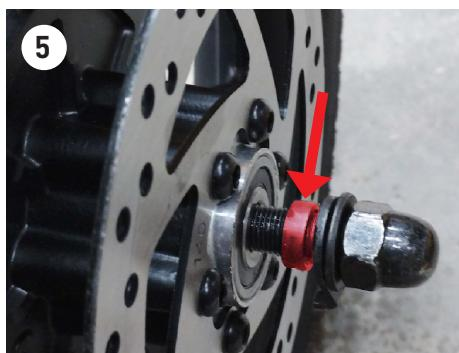
6. Coloque las arandelas de seguridad en los orificios previstos y apriete las tuercas de la rueda.
