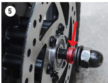
6. Coloque as anilhas de segurança nos orifícios previstos e aperte as porcas da roda.
