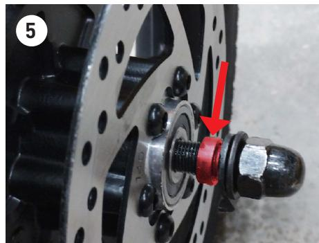
6. Stecken Sie die Sicherungsscheiben in die dafür vorgesehenen Löcher und ziehen Sie die Radmuttern fest an.
