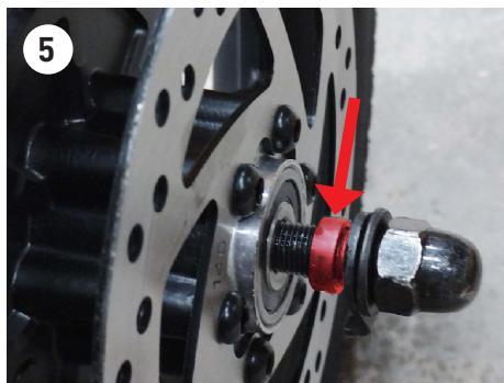
6. 在提供的孔中装入防松垫圈，然后拧紧车轮螺母。
