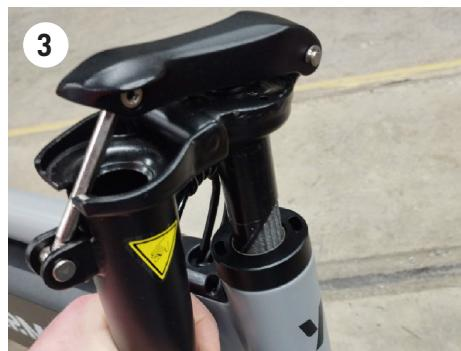
4. Klappen Sie den Lenker zur Hälfte nach oben und ziehen Sie die Schraube in der Mitte sehr fest an.
